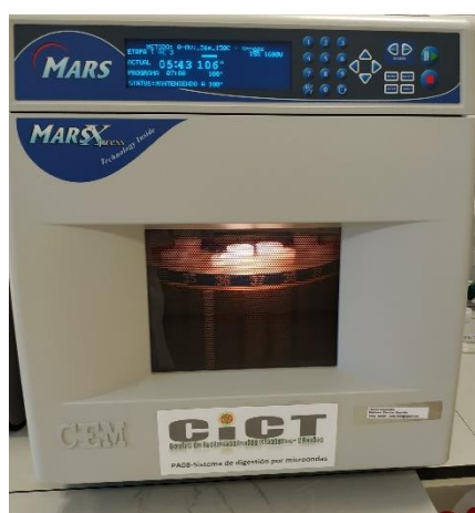
Figura 3. Equipo de microondas, marca CEM, modelo Mars Xpress.
