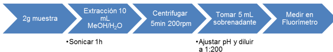
Figura.- 17. Procedimiento extracción sólido- líquido metanol: agua 8:2 (v/v)
