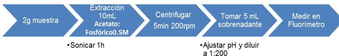
Figura.- 20. Procedimiento extracción sólido- líquido con acetato de etilo: ácido fosfórico 0.5M 10:1 (v/v)
