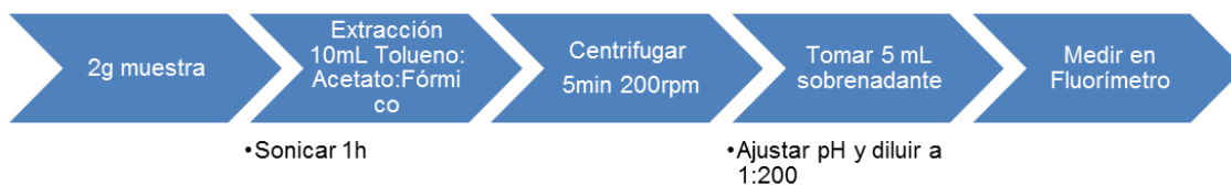
Figura.- 19. Procedimiento extracción sólido- líquido con tolueno: acetato etilo: ácido fórmico 7:3:1 (v/v/v)
